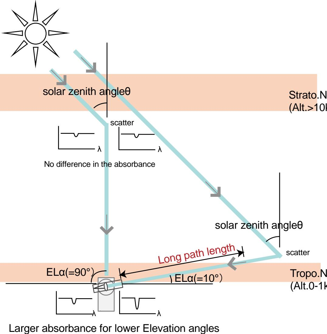
6 elevation angles (EA= 3°, 5°, 10°, 20°, 30°, 90°) are scanned;
